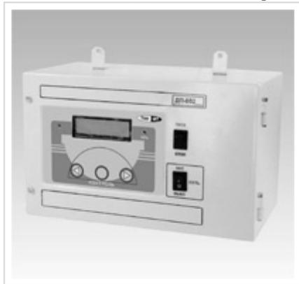
АВТОМАТИКА с микропроцессорным управлением для модульных котельных. Диспетчерский пульт ДП-002Д для дистанционного контроля и управления технологическим процессом работы котельной. Индикация - алфавитно-цифровой ЖКИ (32 символа). Дистанционное управление и индикация по двухпроводной линии до 500 м - интерфейс RS-485
