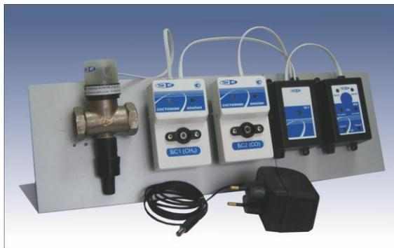
МАГ1- n1n2 предназначен для непрерывного автоматического контроля превышения установленных порогов тревожной и аварийной концентрации горючих и угарного газов в воздухе, где: n1 – число точек контроля горючих газов, n2 число точек контроля угарного газа, при условии n1 + n2 не более 9-ти.
